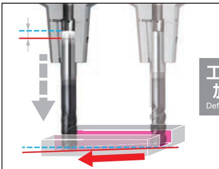
工具抜けによる加工不良発生
