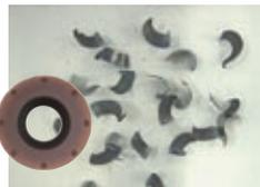
被削材：鋼 S50C (切削条件)  $v_c = 150\text{m/min}$
