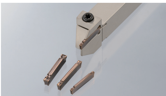
被削材：A5056 3.0mm 幅片肉溝入れ 片肉 2.8mm 加工径： \phi 60\text{mm} 切削条件： v_c=200\text{m/min} n_{\text{max}}=3,500\text{min}^{-1} f=0.05\text{mm/rev} Wet
